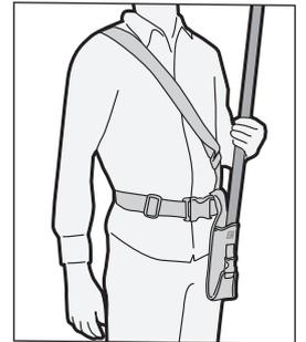
①Bi Rodをホルダーに差し込み、しっかりと固定して使用します。
