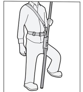
②ハイパーバックルを外し、Bi Rodの底面を地面に固定して使用します。
