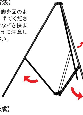
ロッドを上軸受穴から差込みます。下軸受穴にも通し、脚を適度に広げて調整し固定ネジを回してロッドを固定してください。
