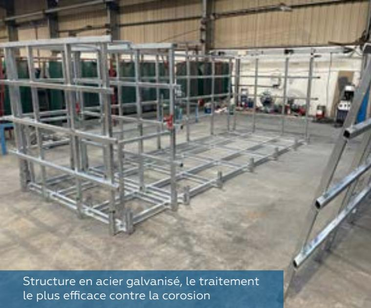
Structure en acier galvanisé, le traitement le plus efficace contre la corrosion
