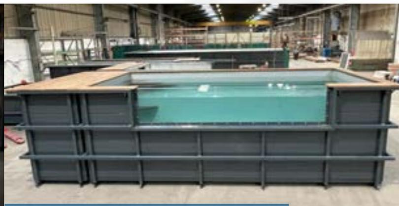
Réalisation de la membrane armée 150/100<sup>e</sup> et mise en eau pour vérifier l'étanchéité
