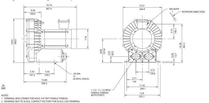
3 CONTACT FACTORY FOR BLOWER MODEL LENGTHS NOT SHOWN.
