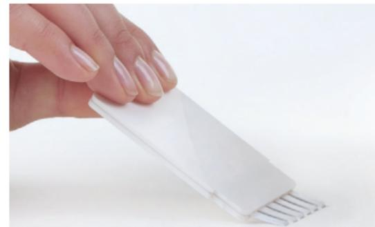
2. Wischen Sie mit dem freien Ende der Teststreifen über eine oder mehrere verdächtige Oberflächen.
