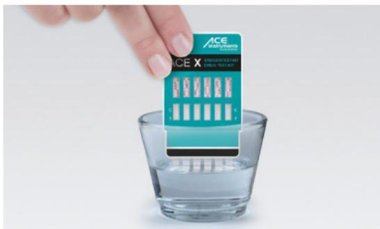
2. Zur Direktaufnahme der Probe ohne Pipette, tauchen Sie die Teststreifen mindestens 10-15 Sekunden lang senkrecht in den Urin. **Achten Sie darauf, dass die schwarze Linie nicht mit dem Urin in Berührung kommt.**
