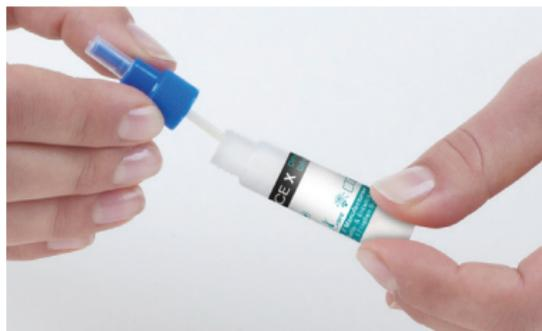
1. Nehmen Sie die Flasche mit dem Fließmittel aus der Verpackung. Schrauben Sie die blaue Kappe ab. Geben Sie einen bis drei Tropfen von der verdächtigen Flüssigkeit in die geöffnete Flasche. Drehen Sie diese wieder fest zu und schütteln Sie die Flasche.
