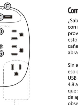
(F) Luz Verde “Grounded” – Te hace saber que el tomacorriente al que estás conectado tiene una conexión a tierra. Si esta luz no se prende, no es bueno, utiliza otro.
