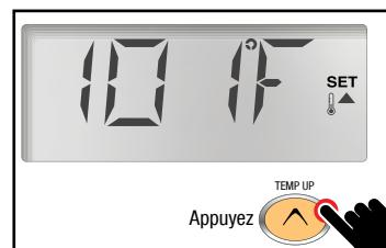
Appuyez sur le bouton "TEMP UP" ou "TEMP DOWN" pour régler la température souhaitée pendant que les chiffres clignotent
