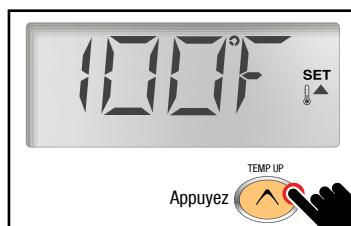
Appuyer sur le bouton "TEMP UP" ou le bouton "TEMP DOWN" fera clignoter la température actuellement réglée
