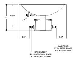
**BURNER FRONT ELEVATION**
