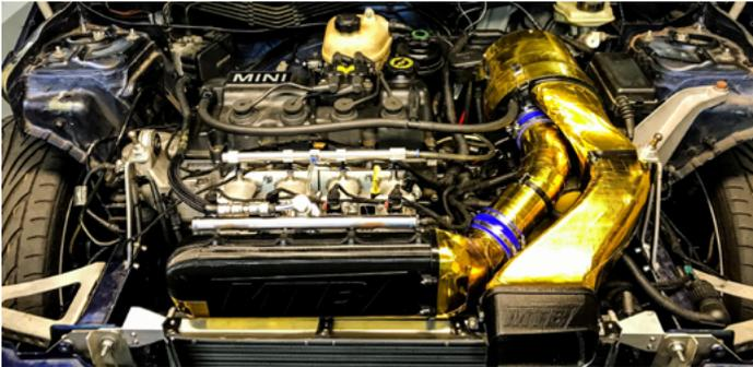
Um die Verdichtung auf 12:1 zu erhöhen ist Kopf und Block geplant. Der Zylinderkopf ist komplett bearbeitet und mit einer scharfen Nocke in Kombination mit härteren Ventildfedern ausgerüstet, allerdings noch mit Serienventilen.
