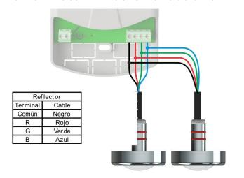
4.2 EJEMPLO DE APLICACIÓN DEL REFLECTOR MONOCROMÁTICO EN UN MODULO THOLZ
