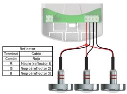
4.3 EJEMPLO DE APLICACIÓN DEL REFLECTOR MONOCROMÁTICO EN UNA FUENTE THOLZ
