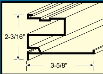
En muro #3 con receptor para liner
