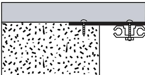
\* El riel por debajo es montado a una placa de acero inoxidable que es asegurada a la parte superior de la pared o sub-deck antes de la instalación
