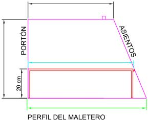
MEDIDAS EN PLANTA DEL MALETERO A 20 cm DE ALTURA (la altura de la parte superior del doble fondo) Las más restrictivas
