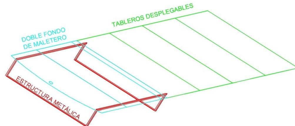
6. Coloque los dos tornillos M8 haciendo coincidir los taladros del tablero de 5 cm de ancho con los "taladros M8" de la estructura metálica y apriételos con la llave "L" que se aporta.
