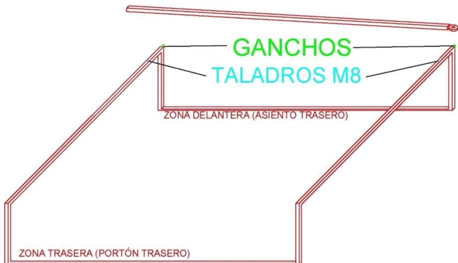
3. Coloque los perfiles sobre los ganchos haciendo que la palometa de ajuste quede hacia el exterior y el gancho y cajillo para encastrar las patas hacia el interior. Despliegue la zona extensible unos 30cm aproximadamente o lo que le permita su asiento delantero.
