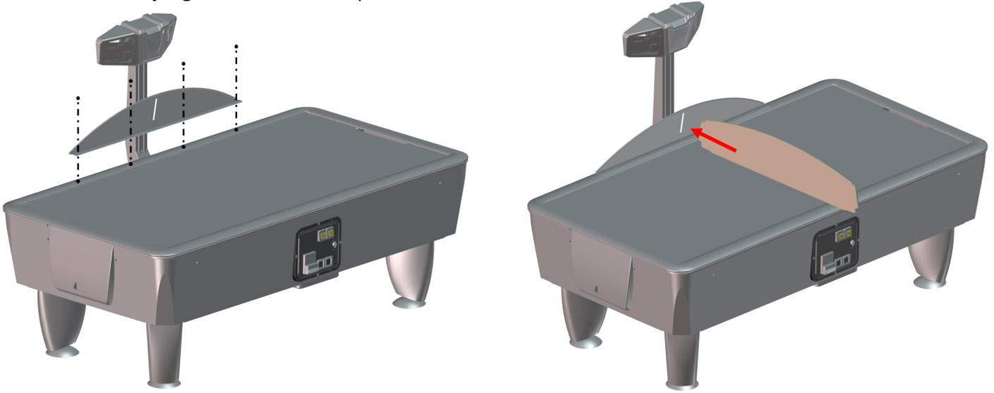
Deslice la protección lateral en la división del área de juego usando tornillos Hex AA6032 8x1/2 con tornillos tek.
