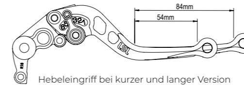
Hebeleingriff bei kurzer und langer Version
