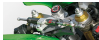
Montage über dem Tank Nicht mit SB-Lenkerkit!
