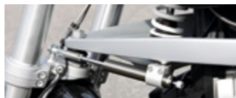
Montage BMW am Längslenker
