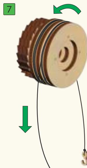
**RU** Второй отрезок дважды накручиваем на второй ролик против часовой стрелки.
