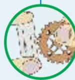
**EN** Lubricate with paraffin. **UK** Змастити парафіном. **DE** Mit dem Paraffin schmieren. **FR** Lubrifier à la paraffine. **IT** Lubrificare con paraffina. **ES** Lubricar con parafina. **PL** Nasmaruj parafiną. **JP** パラフィンで潤滑します。
