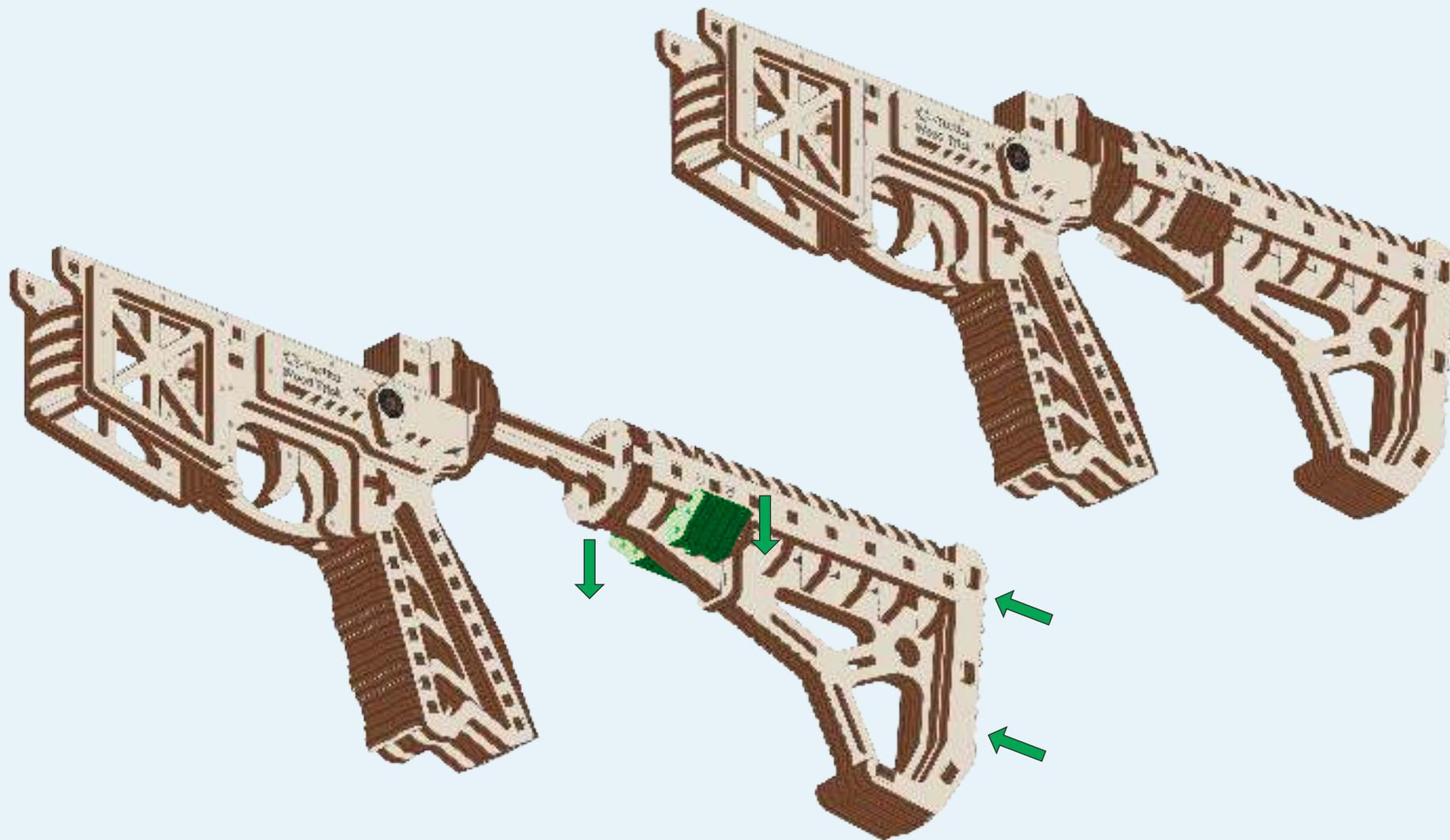
**RU** Для того, чтобы разложить приклад нужно потянуть на себя, а для сброса фиксации необходимо одновременно нажать 2 пальцами на рычаг и задвинуть приклад от себя, как показано на изображении.
