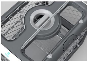
» En commençant avec le côté droit ou gauche du séparateur, pivoter le verrou du séparateur, jusqu'à ce qu'il soit sur le côté
