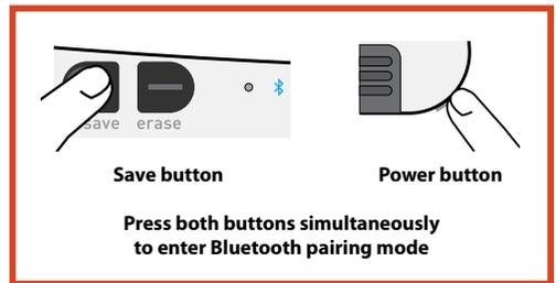
Deaktivieren der Bluetooth-Konnektivität: Schalten Sie den Boogie Board Sync eWriter aus. Halten Sie dann die **LÖSCHTASTE** gedrückt und drücken Sie die **EIN/AUS-TASTE**. Bluetooth muss möglicherweise in Flugzeugen und anderen Umgebungen (z. B. Krankenhäusern) deaktiviert werden. (e.g., hospitals).
