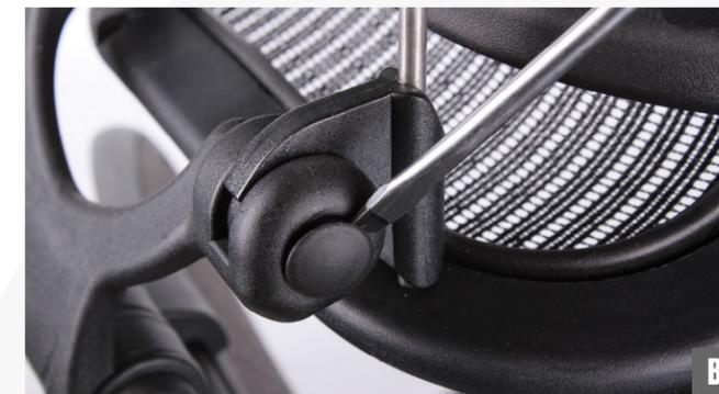
Una volta tolti i cappucci, utilizzare il cacciavite Philips per stringere o allentare le viti e ruotare di ¼ fino a raggiungere la resistenza desiderata (C). NON STRINGERE ECCESSIVAMENTE!, Al termine, riposizionare i cappucci circolari (D).
