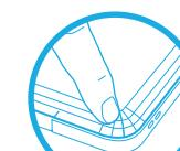
温めた端末に貼り、角をしっかりと押さえてください。最初の2、3日は、接着剤をしっかりと硬化させるため、角に負担をかけないでください。
