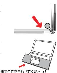
キットに底面カバーが含まれている場合は、上部と同じ方法で貼り付けます。ヒンジの切り込みに合わせて、微調整が必要であれば、カバーをずらして位置をあわせてください。
