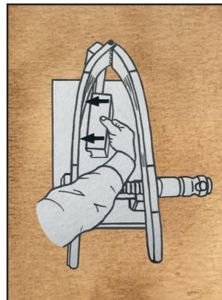
Posizionare il riduttore sul lato interno della morsa. Se il volume del prosciutto è particolarmente ridotto, posizionare entrambi i riduttori sui due lati.
