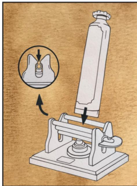
Inserire l'estremità del tubetto nella fessura della chiavetta e ruotare.
