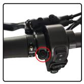
2.MAKE SURE THE BRAKE LEVER SCREWS ARE TIGHTENED.
