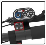
1.CHECK WHETHER THE LED CONTROL PANEL SCREWS AND THE BRAKE LEVER SCREWS ARE TIGHTENED.
