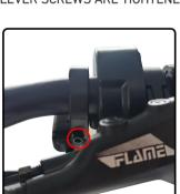
3.CHECK WHETHER THE AMBIENT LIGHT BUTTON SCREWS ARE TIGHTENED.
