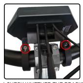
4.CHECK WHETHER THE BRACKET SCREWS ARE TIGHTENED.
