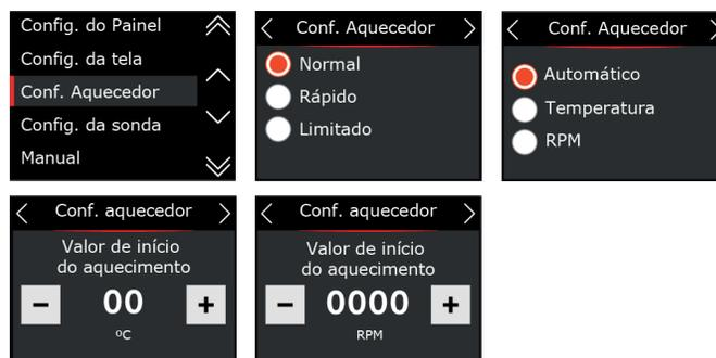
**Rápido:** aquecimento rápido, utiliza uma alta corrente para diminuir o tempo de aquecimento. Ao usar esta opção a vida útil da sonda será reduzida drasticamente.
