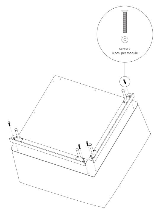
9 LOWER LINKING BRACKET ON CORNER CONFIGURATION
