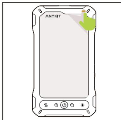
**Schritt 1:** Entfernen Sie die Plastik-Bildschirmabdeckung.
