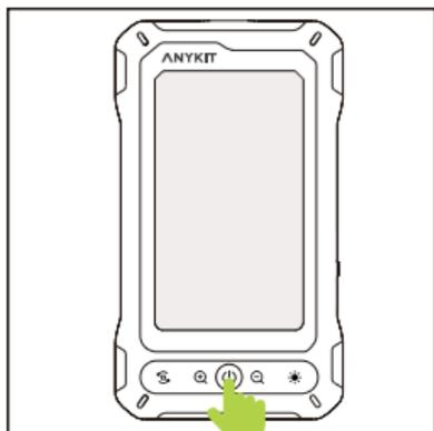
**Schritt 2:** Schalten Sie die Kamera ein/aus (Drücken und halten Sie die “
