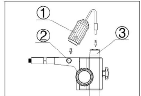
5. Después de montar el soporte de enfoque en la base (si aún no está instalado) adjunto en el envío), deslice el objetivo del microscopio en el orificio y asegúrelo con el tornillo de bloqueo de cabeza incluido.
