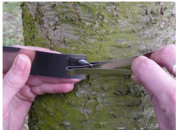
3/ Coloque la escala en la posición correcta y enrolle la cinta alrededor del tronco.
