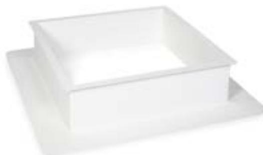
Les costières inclinées présentent une différence de 20 cm entre la mesure jour et l'ouverture de toiture et sont disponibles en trois hauteurs : 15 cm (PO 15/20), 30 cm (PO 30/20) et 50 cm (PO 50/20). Les costières de 30 cm sont disponibles avec différentes épaisseurs d'isolation ; les D30 EP60 et D30 EP 100 sont superisolantes. Ces costières sont pourvues sur leur face extérieure d'une isolation PUR supplémentaire encapsulée d'une épaisseur de 60 ou 100 mm.
