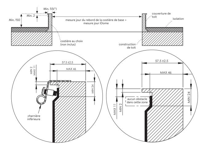
Remarque : Pour certaines costières en PVC (p. ex. PVC 20/00 EP) ce système de charnière de fixation ne sera pas compatible. Pour le montage sur les costières PVC Skylux (p. ex. PVC 20/00 EP), la technique de montage standard avec les clips est recommandée.
