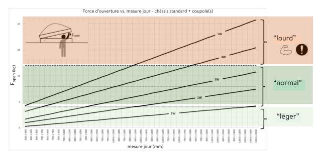
Graphique : châssis en PVC standard en combinaison avec une coupole à 1, 2, 3, 4 ou 5 parois :
