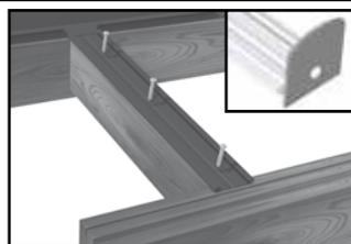
3. Posez les profilés TPV et TPHL jusque contre le profilé MP et vissez-les tous les 50 cm sur les porteurs en bois. Vissez l'arrêt S38.3 au côté perforé des porteurs de vitrage TPV & TPGL.
