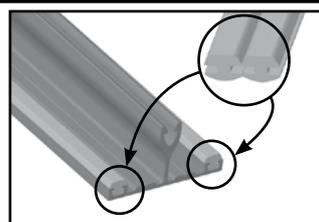
4. Placez les joints de support C3 dans les profilés porteurs et latéraux. Les joints sont fabriqués en double et il faut les séparer avant de les placer.
