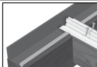
4. Adaptez les porteurs de vitrage TPV et TPGL à la longueur désirée et glissez-les dans les profilés en aluminium jusque contre le profilé mural MP. Bloquez-le uniquement en haut avec 2 vis. Fixez le joint C31 dans le profilé MP.
