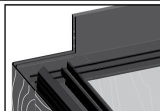
4. Fixez les profilés T16P jusqu'au profilé MP. Vissez avec vis à tête noyée dans les lumières pratiquées dans le T16P.
