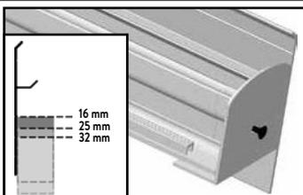
5. L'extrémité du profil T16P vient au même niveau que le côté frontal de l'arrêt. Positionnez le L16P selon l'épaisseur de la plaque.
