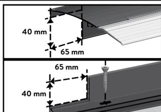
2. Enlevez 65 mm (gauche & droite) de la partie verticale des profilés muraux MP et CLM. Vissez le MP sur le chevron avec vis à tête noyée. Glissez le joint C1CX dans le CLM.
