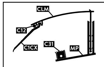
8. Clipsez le clips mural CLM avec le joint C1CX dans le profilé mural MP. Fixez ensuite le joint rond C12 entre le CLM et le C1CX pour renforcer la pression sur les plaques.
