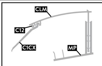
7. Installez le joint C12 rond entre le clips mural CLM et le joint C1CX pour augmenter la pression sur les plaques.
