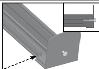
3. Découpez 25 mm du joint coex en bas du T16P et LP. Vissez l'arrêt S16.3/S32.3 avec vis RVS.
