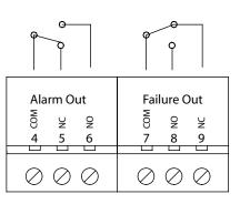
Contact d'alarme sans potentiel Com + NO connectés en cas d'alarme. Max 48V 0,5A Contact d'erreur sans potentiel Com + NC connectés en cas d'erreur
