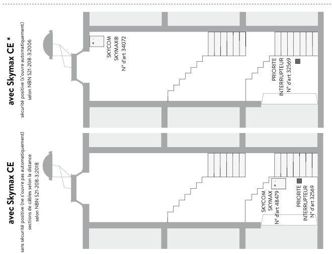
\* Important! Dans le cas d'une centrale SKYCOM SKYMAX avec sécurité positive, il faut toujours installer une centrale Skycom (Slave ou Skymax) au plafond, le plus près possible du système ouvrant
