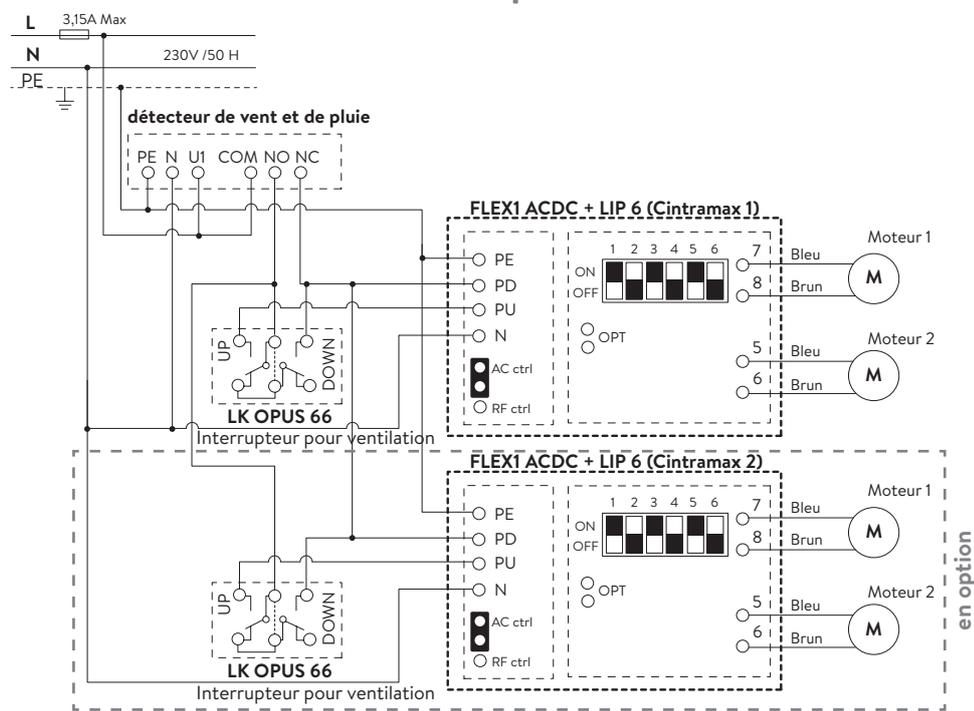
Pour un détecteur de pluie, il est possible de brancher 2 ventilations Cintramax au maximum.
