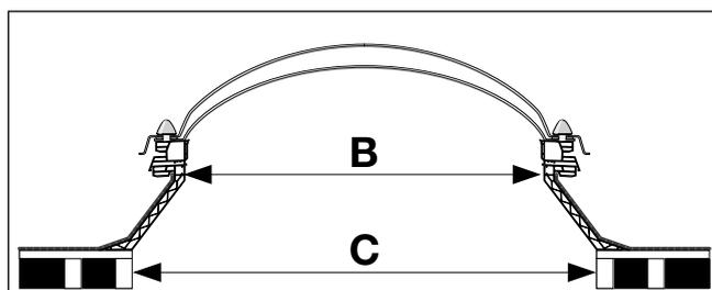
Bei einer Kuppelanierung nimmt man gewohnheitsgemäß die Abmessungen der aktuellen Kuppel als Referenz. Bitte beachten Sie aber, dass die übermessene Abmessung 16 cm größer als das Tageslichtmaß ist (Maß B +16 cm = übermessene Abmessung), da die Kuppel rundum einen Flansch von 8 cm hat.
