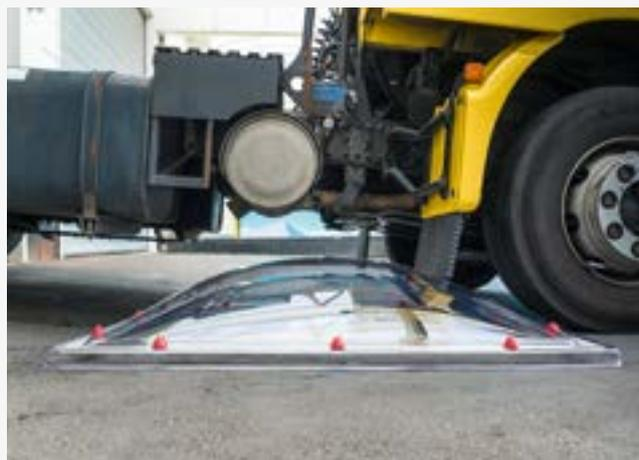
Test mit Skylux Panzerkuppel aus Polycarbonat: Die Kuppel zerbricht nicht, sondern geht ohne Schaden wieder in die ursprüngliche Form zurück.
