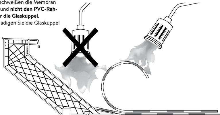
Achten Sie darauf, dass Sie beim Schmelzschweißen die Membran erhitzen und nicht den Aufsatzkranz.
