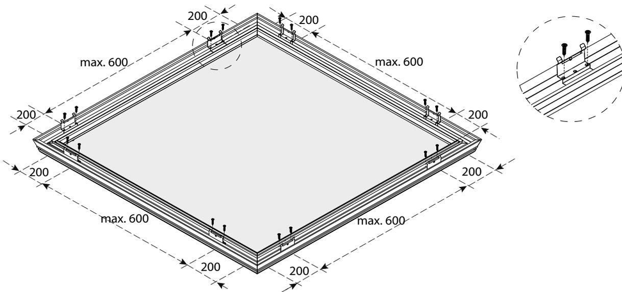
Drehen Sie das komplette System um und stellen Sie dieses über den Aufsatzkranz! Sorgen Sie dafür, dass die Clips, komplett mit Fenster und Glas, nicht direkt auf die Dachbedeckung oder auf den Untergrund gepostet werden (um möglicher Beschädigung an der Dachbedeckung oder an den Clips vorzubeugen). Das Fenster auf dem Aufsatzkranz anbieten und den Spielraum gleichmäßig über die 4 Seiten des Aufsatzkranzes verteilen. Mit einem einfachen Druck auf das Fenster klipst es über den Aufsatzkranz.
