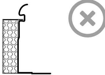
**Falsch:** Dachbedeckung bis über den Flansch ziehen
