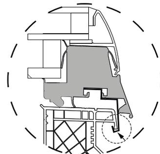
Für eine zusätzliche Verstärkung, bitte schrauben Sie die Clips quer durch den Aufsatzkranz mit mitgelieferten Schrauben.
