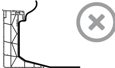
**Falsch:** Dachbedeckung bis über den Flansch ziehen
