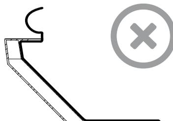
**Falsch:** Dachbedeckung bis über den Flansch ziehen
