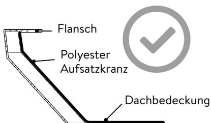
**OK:** Dachbedeckung bis unter den Flansch ziehen
