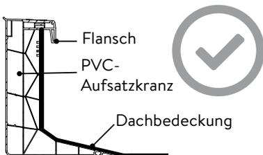
**OK:** Dachbedeckung bis unter den Flansch ziehen
