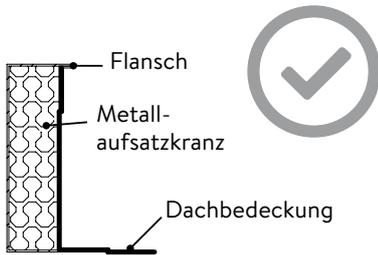
**OK:** Dachbedeckung bis unter den Flansch ziehen
