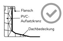
**OK:** Dachbedeckung bis unter den Flansch ziehen
