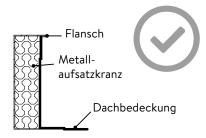
**OK:** Dachbedeckung bis unter den Flansch ziehen
