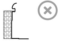
**Falsch:** Dachbedeckung bis über den Flansch ziehen
