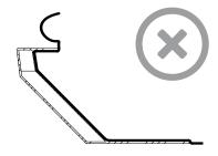
**Falsch:** Dachbedeckung bis über den Flansch ziehen
