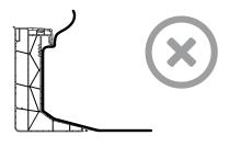
**Falsch:** Dachbedeckung bis über den Flansch ziehen
