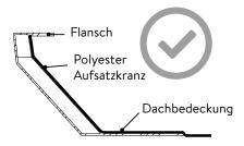
**OK:** Dachbedeckung bis unter den Flansch ziehen
