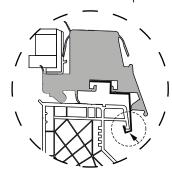
Für eine zusätzliche Verstärkung, bitte schrauben Sie die Clips quer durch den Aufsatzkranz mit mitgelieferten (Einweg-)Schrauben.
