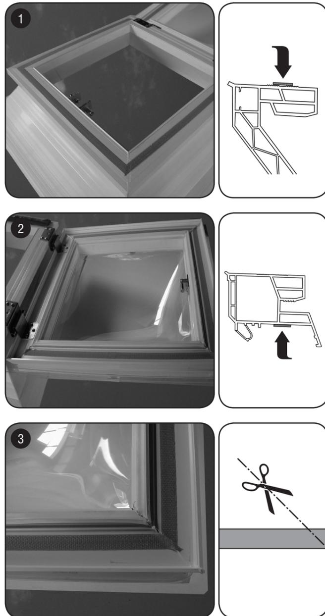
**1** Entfetten Sie den Flansch des Aufsatzkranzes mit Thinner. Kleben Sie das Hakenband auf die gerippte Zone des Flansches vom Aufsatzkranz. Die Scharnierseite soll frei bleiben, so dass die Vorderseite und die zwei Längsseiten von Insektenschutz versehen sind.
