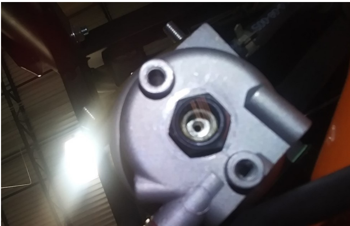
Fig. 9: Carburetor bowl bolt.
