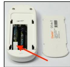
**Fenstersensoren:** Entfernen Sie den weißen Batterieschutz an der Unterseite des Sensors durch Ziehen.
