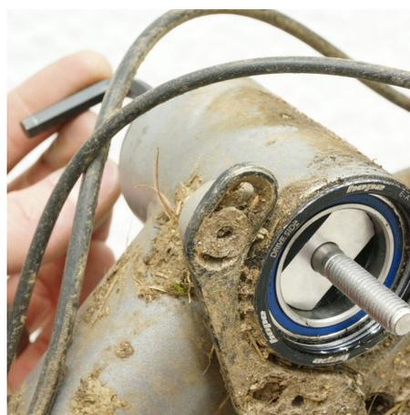
Utilizzare una chiave a brugola da 6 mm per tenere fermo il bullone e impedirne la rotazione.
