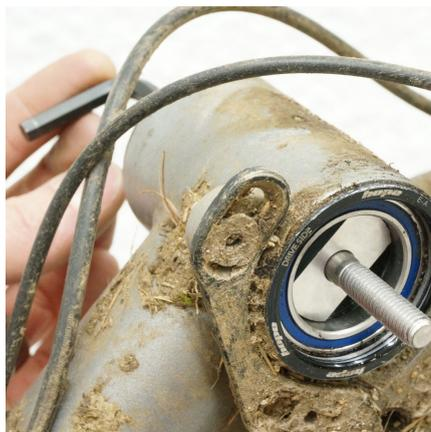
Utilisez une clé Allen de 6 mm pour maintenir le boulon en place et l'empêcher de tourner.
