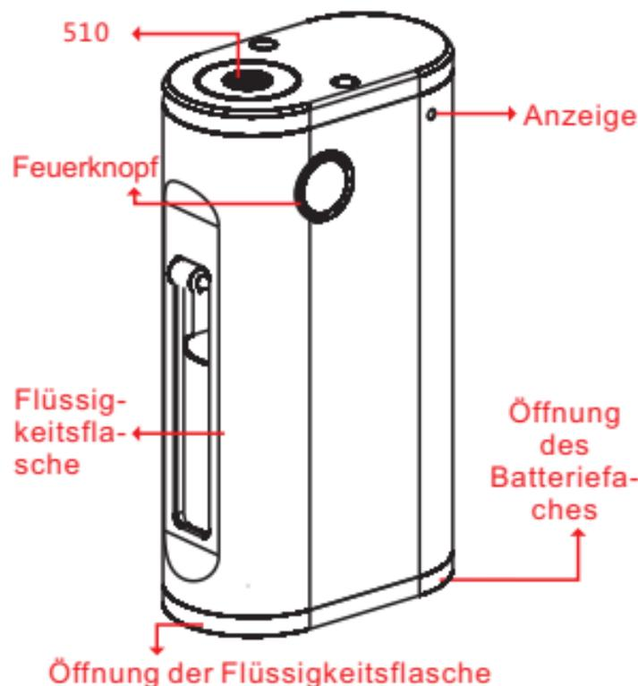
**Ein- und Ausschalten:** Drücken Sie den Feuerknopf 5 Mal, um das Gerät ein- und auszuschalten. Eine grüne Leuchte zeigt an, dass das Gerät eingeschaltet ist. Eine blaue Leuchte zeigt an, dass das Gerät ausgeschaltet ist.
