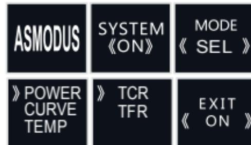
CURVE参数值；短按“FIRE”键可选择编辑参数类型，长按“FIRE”确认选择CURVE模式并退出到工作界面。在工作界面中可同时按下“+”“-”键进入参数调整，再次同时按下“+”“-”键则可退出参数调整。此模式共有5个曲线点，每个曲线点有功率和时间两个参数，功率参数为工作时的输出功率，时间参数为输出功率所持续的时间。
