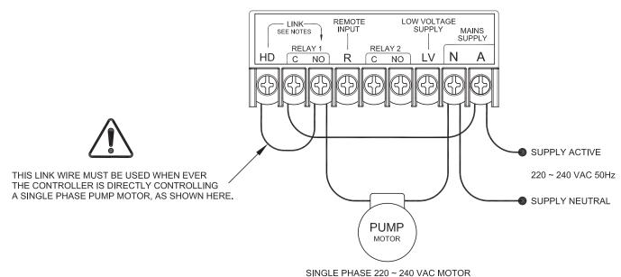
MAXIMUM MOTOR LOAD 2.4 kW
