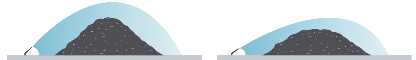
Different trajectory angle adjustments to suit the stock pile configurations. Ajustes variables del ángulo de trayectoria del chorro, para poder adaptarse a la configuración de las escombreras.
