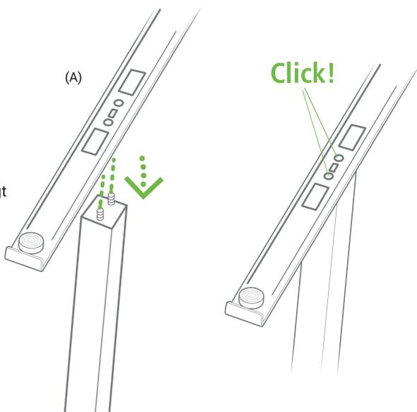
Hinweis: Das Bedienelement ist vormontiert auf der rechten Seite und kann bei Bedarf auch links (in die vorgebohrten Löcher) montiert werden.
