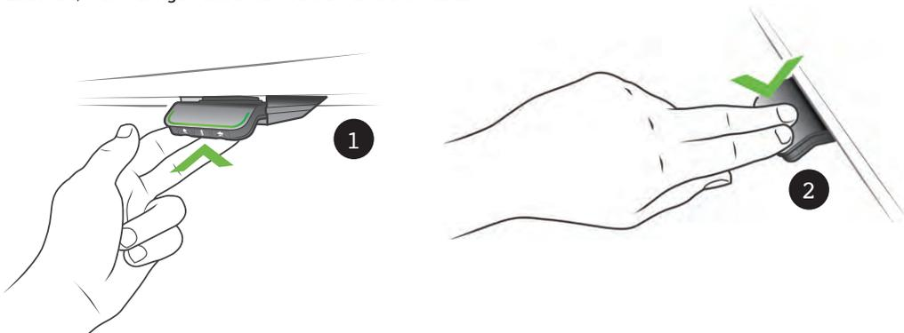
Der Handschalter verfügt über drei Bedientasten und über ein OLED-Display, auf dem die Höhe des Tisches und viele andere Texte als Orientierungshilfe angezeigt werden.
