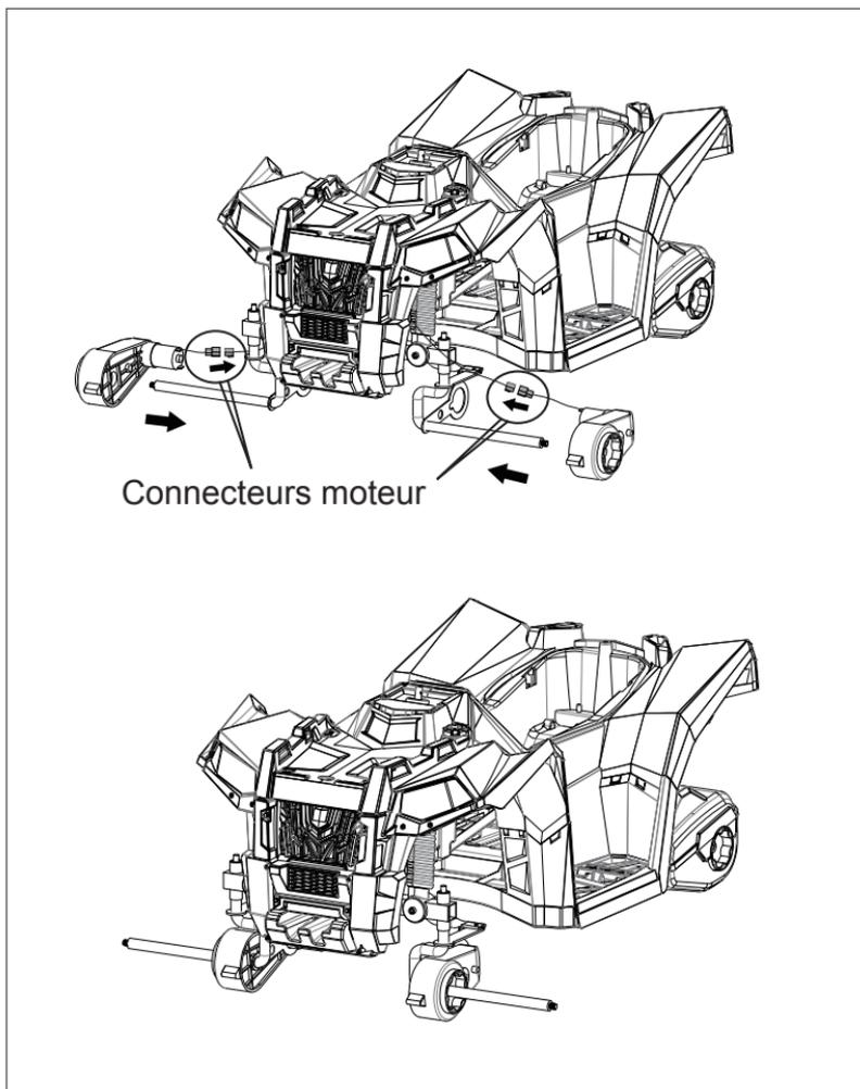
6. Ensemble de pièces de connexion de conduite
