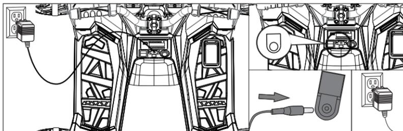
1. Insérez d'abord la fiche du chargeur dans le port de charge.
