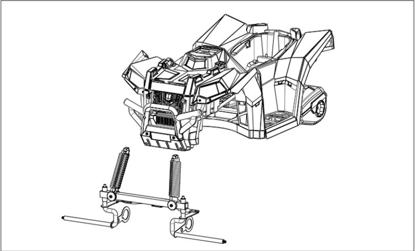
4. Ensemble tige de direction et cadre d'essieu avant Insérez la tige de direction à travers la carrosserie de la voiture, alignez l'extrémité de la tige de direction avec une boucle sur le cadre d'essieu avant. Fixez les ornements d'amortisseur et le cadre de l'essieu avant avec les ouvertures de la carrosserie de la voiture, fixez le cadre de l'essieu avant avec quatre vis de chaque côté. Placer la rondelle sur la tige de direction et la fixer avec la goupille fendue fournie.
